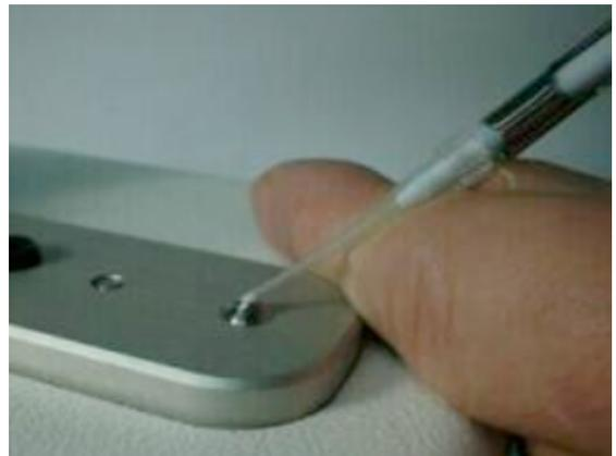
2. Une fois le bras abaissé au niveau horizontal, un système d'aimant est activé et le bras comprime la goutte de liquide, formant une colonne de liquide une fois revenu à sa position horizontale. L'échantillon est maintenu entre les deux surfaces de lecture par tension de surface, permettant la mesure du spectre. La mesure du spectre est alors réalisée et la quantification est basée sur le trajet optique de 1 mm.
